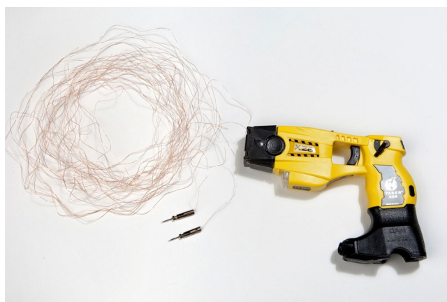
Fig. 1 Taser ® X26. Le dispositif propulse deux fléchettes barbelées reliées au pistolet par des fils conducteurs isolés, transmettant la décharge électrique (photo CEMCAV-CHUV)
